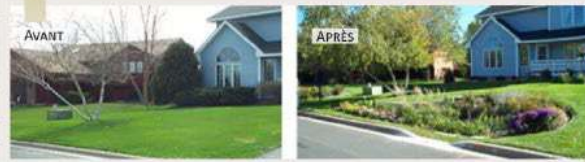
Ces nouvelles plates-bandes absorbent les eaux du toit et du caniveau.
